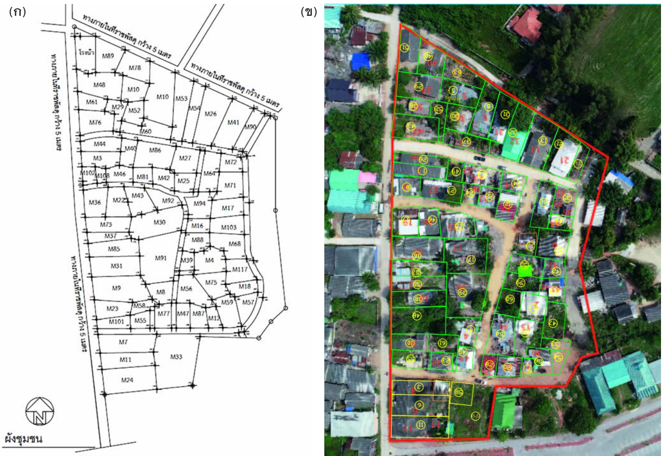
ภาพที่ 11 (ก) การกำหนดขอบเขตผังพื้นที่ของบ้านโดยใช้เครื่องวัด GPS และ (ข) การนำผังที่รังวัดเทียบกับพื้นที่จริง
