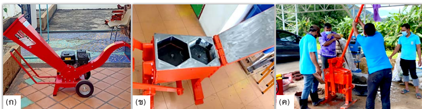
ภาพที่ 4 (ก) เครื่องสับย่อยชนิดปากแตร (ข) เครื่องอัดบล็อกแบบมือโยก และ (ค) กระบวนการผลิตบล็อกทางเท้าโดยชุมชน
