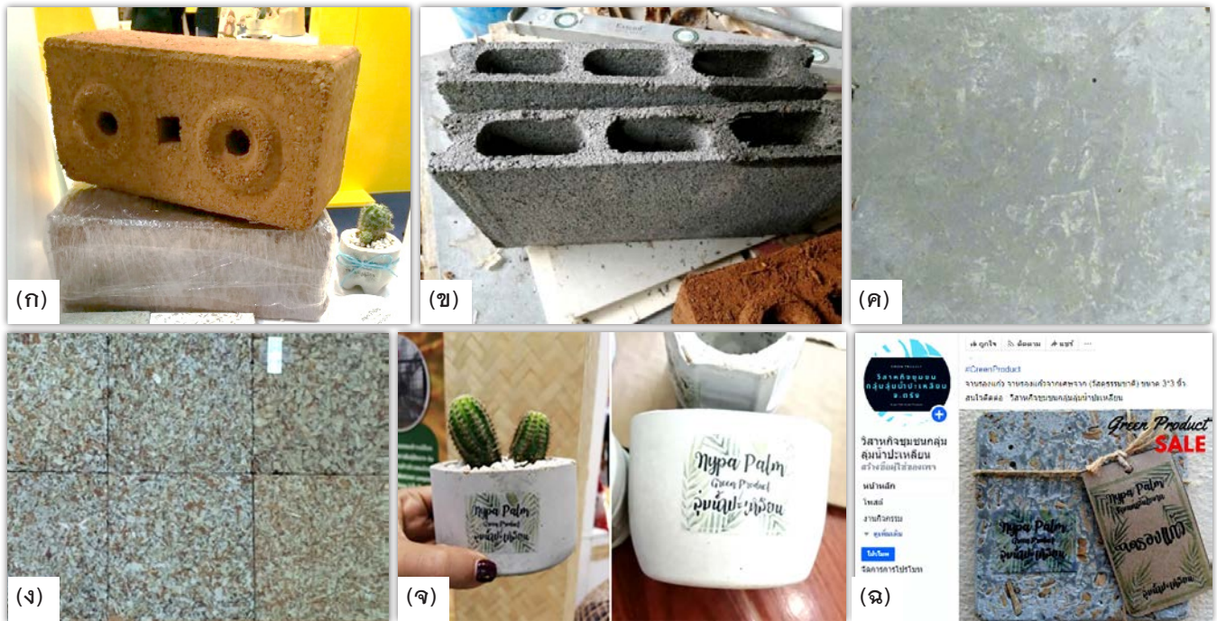
ภาพที่ 12 (ก) อิฐบล็อกประสานเส้นใยจาก (ข) อิฐบล็อกซีเมนต์เส้นใยจาก (ค) ซีเมนต์บอร์ดเส้นใยจาก (ง) แผ่นผนังจากเศษจาก (จ) กระถางรักษ์โลก และ (ฉ) ฐานรองแก้ว หรือโมเสคเส้นใยจาก
