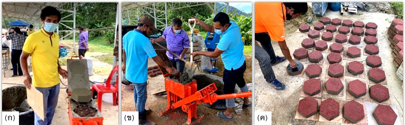
ภาพที่ 9 (ก) การถ่ายทอดองค์ความรู้ในการใช้เครื่องอัดบล็อกทางเท้า และการสาธิตกระบวนการทำบล็อกทางเท้า (ข) ชุมชนช่วยกันทำบล็อกทางเท้า และ (ค) บล็อกทางเท้าที่เกิดจากการเรียนรู้ของคนในชุมชน
