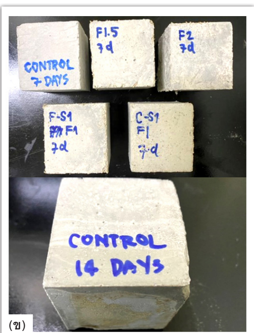
ภาพที่ 3 (ก) สูตรผสมของบล็อกทางเท้าตามอัตราส่วนของวัตถุดิบแต่ละชนิด และ (ข) การทดสอบค่าความต้านทานแรงกดอัดของ บล็อกทางเท้าเส้นใยจาก
