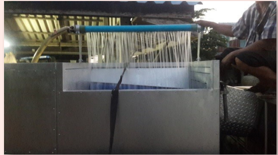
ภาพที่ 7 การทดลองใช้งานเครื่องล้างหัวมันเทศ
