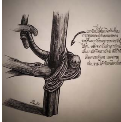
ภาพ 7 โครงสร้างไม้เถาว์ลัยไส่ตัน ยึดขึ้นแรกด้วยตะปู และขึ้นตอนต่อมาพันด้วยเถาว์ลัยเส้น เพื่อให้เกิดความ มั่นคงแข็งแรงของผลิตภัณฑ์เถาว์ลัยจากพื้นที่ป่าชุมชนและทำให้เกิดความงามจากลวดลาย และเส้นสายที่เป็นเสน่ห์น่าหลงใหลของเถาว์ลัย ที่มา : ศรุต ลูกบัว. 2559.
