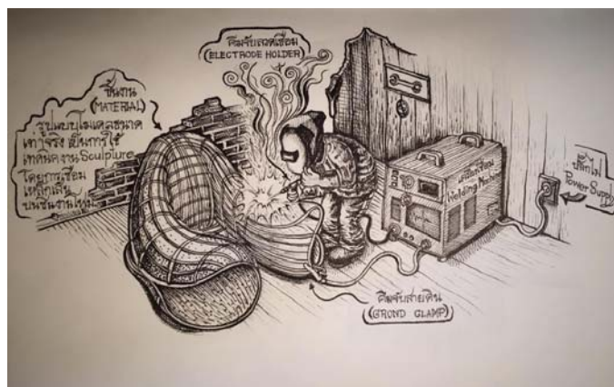
ภาพ 6 ภาพการเชื่อมโครงเหล็กใช้เทคนิคเดียวกับงานประติมากรรมโดยการขึ้นจากวัสดุโฟมเพื่อเป็นต้นแบบก่อนทำ การขึ้นโครงเหล็กทำให้เกิดความมั่นคงและแข็งแรงยิ่งขึ้น ที่มา : ลายเส้นโดย ศรุต ลูกบัว. 2559.
