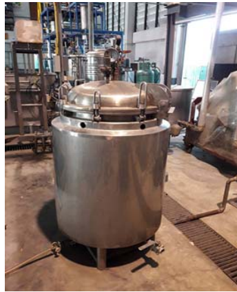
ภาพ 6 การต้มเยื่อและล้างเยื่อหลังจากการต้ม
