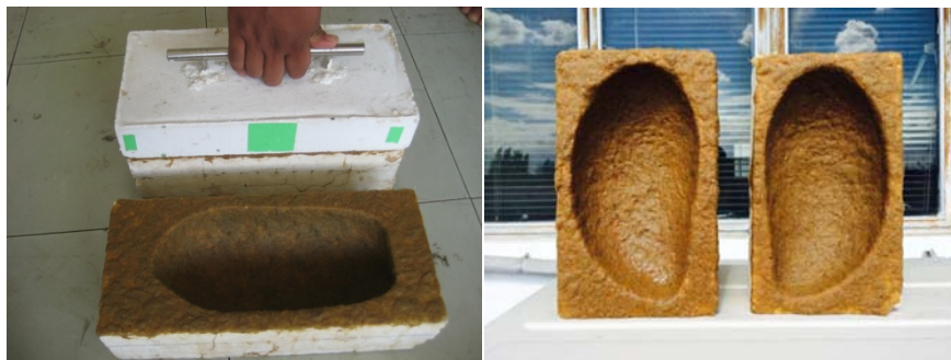
ภาพ 11 นำแม่พิมพ์ตัวผู้กดทับลงบนแม่พิมพ์ที่ทำการตะเยื่อแล้ว (ซ้าย) บรรจุภัณฑ์ที่ได้ (ขวา)
