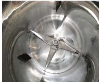
ภาพ 4 ลักษณะชุดใบมีดที่ติดอยู่ที่กลางตัวถัง และด้านข้างของตัวถังที่ทำหน้าที่ในการสับบดเยื่อที่ปั่นอีกครั้ง
