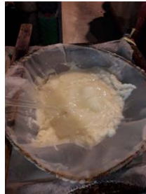
ภาพ 7 การกรองเยื่อและการเอาน้ำออกจากเยื่อเพื่อเก็บเยื่อไว้ใช้
