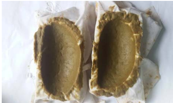
ภาพ 9 การขึ้นรูปโดยการซ้อนเยื่อสำหรับบรรจุภัณฑ์แบบเยื่อกระดาษ (Molded Pulp)
