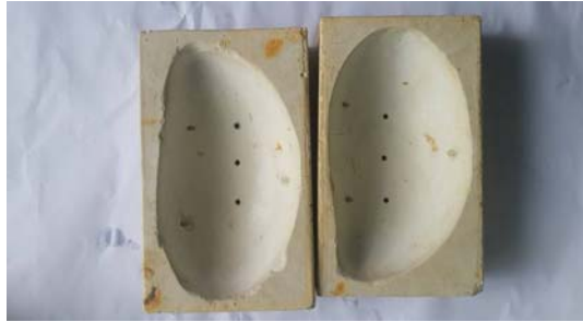
ภาพ 8 เจาะรูแม่แบบผลไม้สำหรับใช้ขึ้นรูปบรรจุภัณฑ์แบบเยื่อกระดาษ (Molded Pulp)
