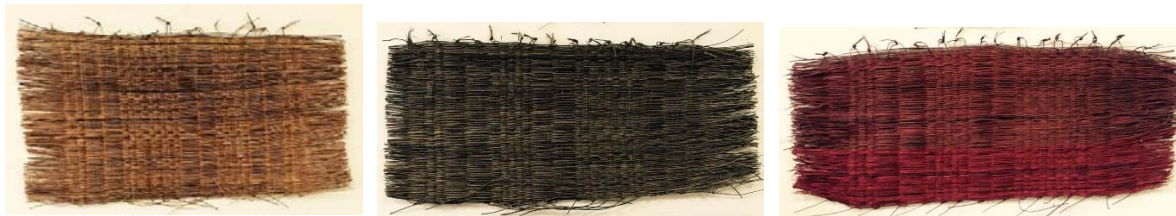
ภาพ 6 กระบวนการขึ้นรูปด้วยการทอด้วยเส้นใยตาลล้วน
