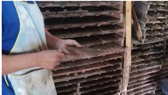
ภาพ 7 แสดงการเก็บขอบกระเบื้องหลังคาดินเผา
