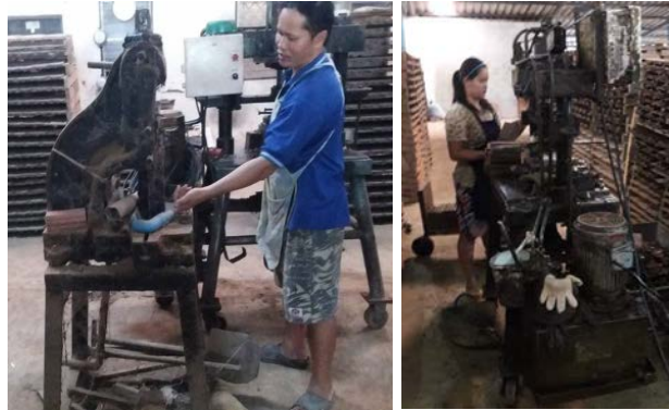
ภาพ 6 แสดงการขึ้นรูปกระเบื้องหลังคาดินเผา
