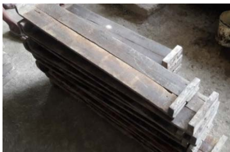
ภาพ 5 ภูมิปัญญาแผ่นไม้ ซึ่งใช้สำหรับขนย้ายแผ่นกระเบื้อง
