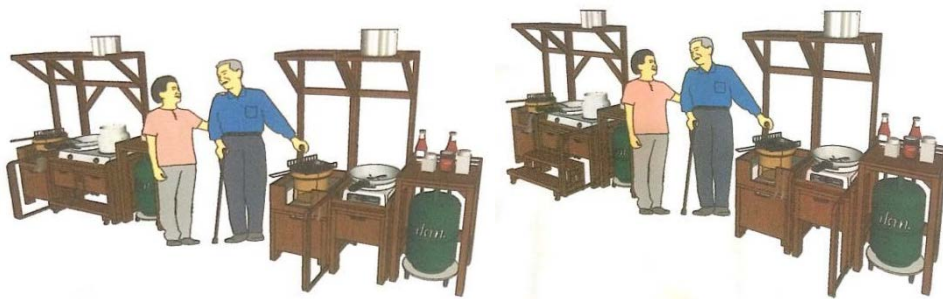
ภาพ 14 แสดงราวจับช่วยพยุงตัวและบันไดที่สามารถเลื่อนเก็บได้
