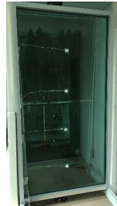
ภาพ 4 แสดงการทดสอบเปรียบเทียบประสิทธิภาพของรูปทรงพืชพันธุ์ที่มีผลกระทบต่อปริมาณความร้อนภายในช่องว่างระบบผนัง DSF ตามเงื่อนไขที่ 1
