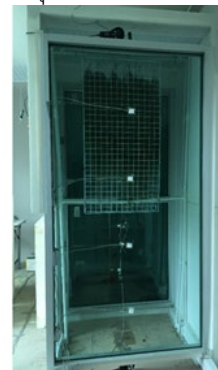
ภาพ 6 แสดงการทดสอบเปรียบเทียบประสิทธิภาพของรูปทรงพืชพันธุ์ที่มีผลกระทบต่อปริมาณความร้อนภายในช่องว่างระบบผนัง DSF ตามเงื่อนไขที่ 3
