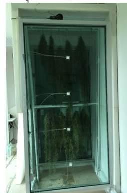
ภาพ 5 แสดงการทดสอบเปรียบเทียบประสิทธิภาพของรูปทรงพืชพันธุ์ที่มีผลกระทบต่อปริมาณความร้อนภายในช่องว่างระบบผนัง DSF ตามเงื่อนไขที่ 2
