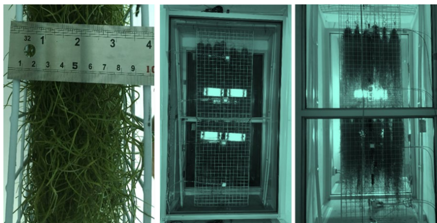
ภาพ 12 แสดงรูปแบบของอุปกรณ์บังแดดที่ควบคุมรูปทรงและมีอัตราส่วนมวลของพืชพันธุ์เท่ากับ 1500 \text{ g/m}^2 พื้นที่ผนัง ติดตั้งกระจายครอบคลุมพื้นผิวผนังทั้งช่วงบนและล่าง
