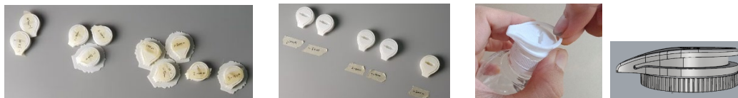
ภาพ 11 แสดงการทดลองสร้างต้นแบบฝาขวด (Mock Up) ด้วยกรรมวิธีการพิมพ์ 3 มิติ ด้วยวัสดุ (ABS Silicone) ระยะเวลาพิมพ์ที่แตกต่างกัน แต่ไม่สามารถทำให้ฝาในส่วนที่มีความหนาบางได้เหมือนการฉีด (Injection)
