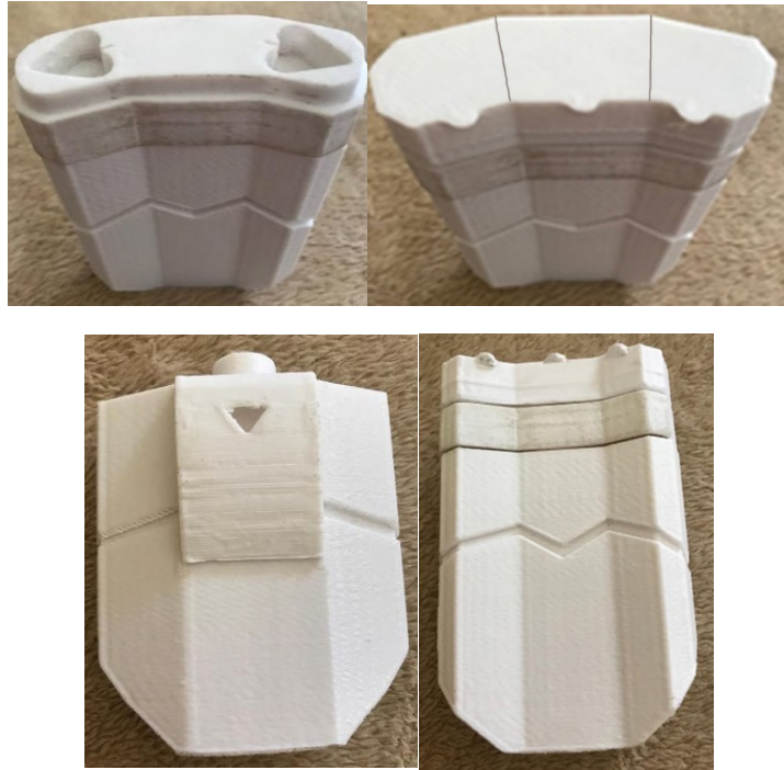
ภาพ 4 ต้นแบบของขวดน้ำดื่มพร้อมกล่องเก็บยาอเนกประสงค์จากการใช้เครื่องพิมพ์สามมิติ
