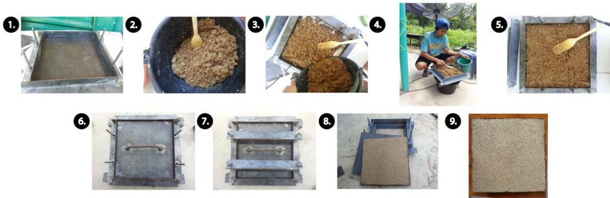
ภาพ 11 กระบวนการอัดแผ่นเพื่อเตรียมการทดสอบตามมาตรฐานผลิตภัณฑ์อุตสาหกรรม
