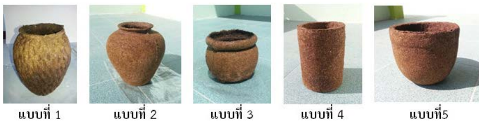
ภาพ 14 รูปแบบที่ได้จากการอัดขึ้นรูปทรง
