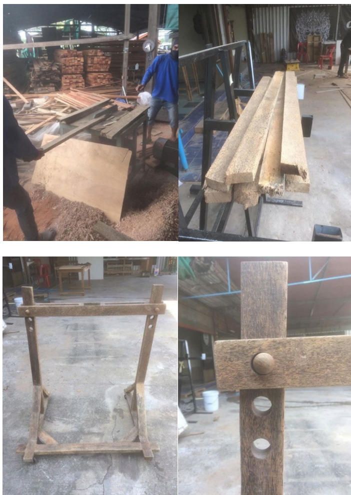
ภาพ 11 โครงสำหรับติดมอเตอร์และใบกวนน้ำตาลโตนด ด้านข้างเจาะรูเพื่อให้ปรับระดับได้
