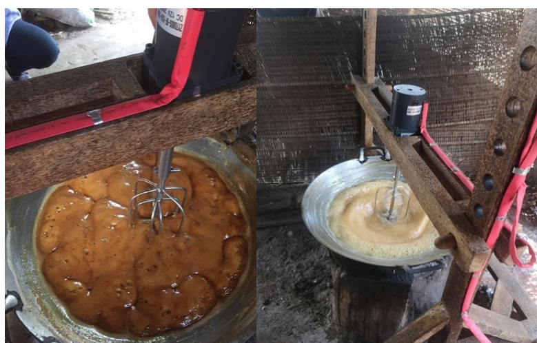
ภาพ 14 ทดสอบประสิทธิภาพของการกวนน้ำตาลโตนดโดยใช้พลังงานจากแสงอาทิตย์
