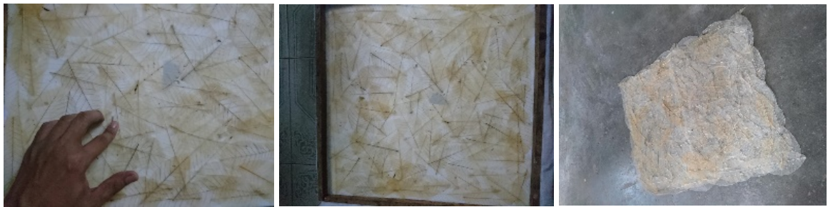
ภาพ 14 แสดงขั้นตอนการจัดวางใบยาง (การต้มใบยางพาราด้วยโซดาไฟ) ที่มา : พิษณุ อนุชาญ, 2563
