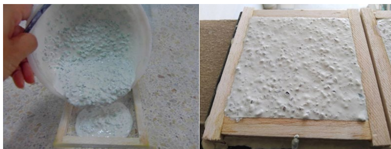
ภาพ 2 หล่อชิ้นงานลงแม่พิมพ์ ขนาด 10 x 10 x 1 ลูกบาศก์เซนติเมตร
