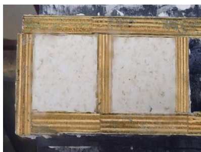
ภาพ 3 หล่อขึ้นงานลงแม่พิมพ์ ขนาด 5 x 5 x 5 ลูกบาศก์เซนติเมตร
