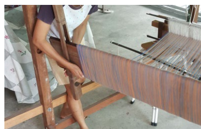
ภาพ 14 การติดตั้งกระดานหูกบนกี่ทอผ้า
