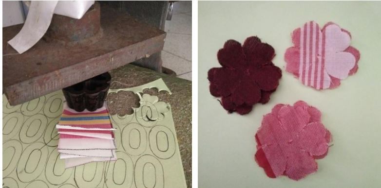
ภาพ 11 นำผ้าขาวม้าพับตามสีที่ต้องการ ใช้กระดาษแข็งรองด้านล่างของผ้า นำไปวางบนแป้นรองพิมพ์ รูปกลีบดอกไม้ จากนั้นหมุนเครื่องตอกกลีบจนกว่าผ้าจะขาดเป็นรูปกลีบดอกไม้ตามแบบพิมพ์
