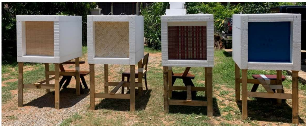
ภาพ 4 การติดตั้งวัสดุในการทดลอง
