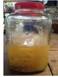
ภาพ 7 การแช่แก้วพลาสติกPSในตัวทำลายน้ำมันเบนซิน
