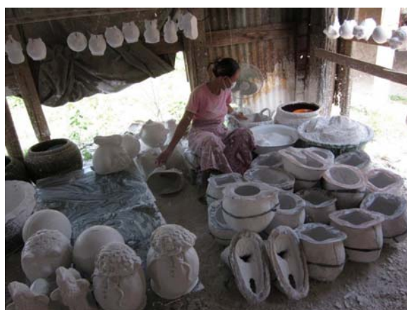
ภาพ 6 พิมพ์ด้วยปูนปลาสเตอร์ ทิ้งให้แห้งหลังจากนั้นหล่อด้วยน้ำปูนปลาสเตอร์ 2 รอบโดยทิ้งห่างกันประมาณครึ่งชั่วโมง
