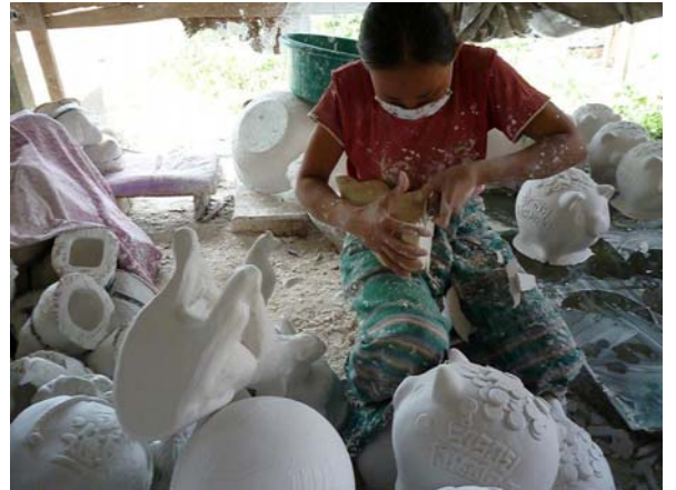
ภาพ 8 หล่อปิดกั้นอมสินและการเก็บรายละเอียดขอบชิ้นงานให้เรียบร้อย
