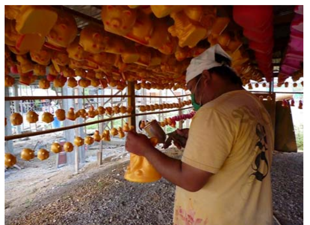
ภาพ 12 พ่นสีน้ำมันโดยช่างผู้ชำนาญในชุมชน
