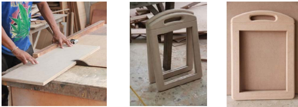
ภาพ 2-4 ขั้นตอนการผลิตตู้ถ่ายซิลค์สกรีนโดยใช้ตู้ถ่ายแสงแดด(ชุดทดลองสอน)
