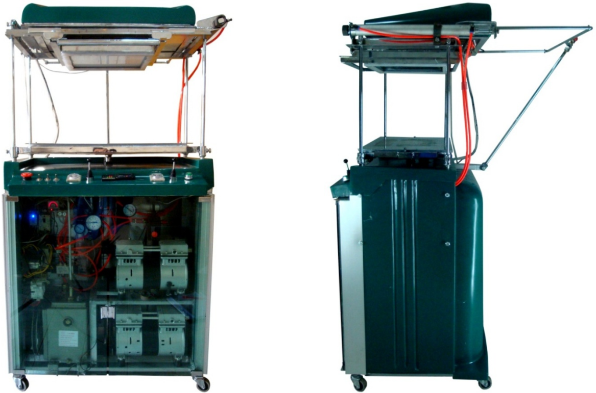
ภาพ 7 แสดงมุมมองในภาพด้าน 2 มิติของตัวเครื่องขณะกางแขนในส่วนบนออกเพื่อการใช้งาน
