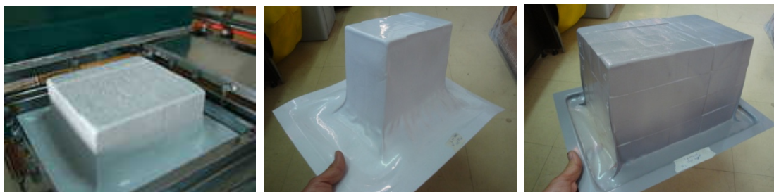
ภาพ 10 แสดงตัวอย่างรูปทรงของแผ่นพลาสติกที่ผ่านเกณฑ์การทดสอบ
