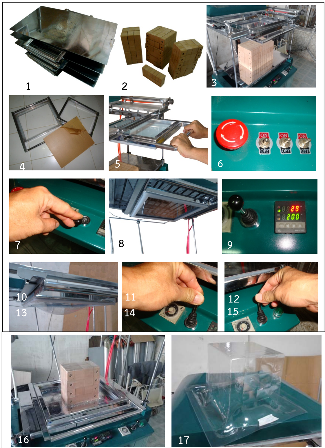
ภาพ 9 แสดงขั้นตอนการใช้เครื่องและรูปทรงของแผ่นพลาสติกที่ได้จากการทดสอบ
