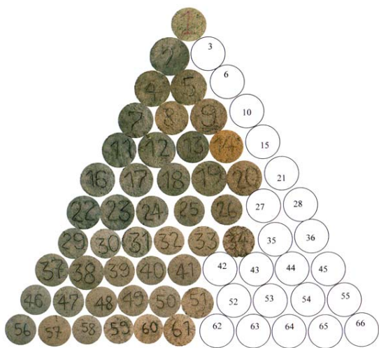
ภาพ 2 ความเหมาะสมในการขึ้นรูปของชิ้นงาน ตามส่วนผสมใน Triaxial Blend โดย เป็น ส่วนผสมที่ไม่สามารถขึ้นรูปได้
