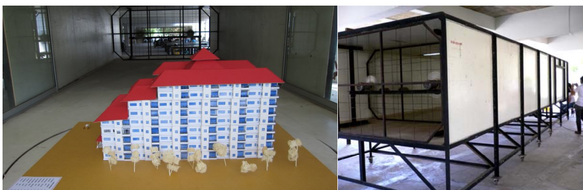
ภาพ 2 อุโมงค์ลมสำหรับทดลองและเก็บข้อมูลความเร็วของกระแสลมที่ผ่านเข้าไปในอาคารโดยใช้หุ่นจำลอง
