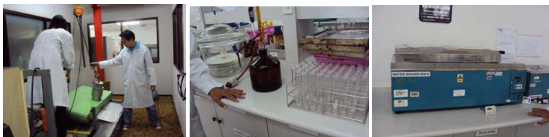
ภาพ 4 แสดงภาพถ่ายการทดสอบประสิทธิภาพเตียงนอนพักกลางวัน จากกระดาษรีไซเคิล โดยหาคุณสมบัติความแข็งแรง ความคงทน ซึ่งสามารถนำมาเทียบเคียงกับมาตรฐาน ( มอก. 1154 - 2536 ) การประเมินความพึงพอใจ ของครูและครูผู้ช่วย ผู้วิจัยได้ดำเนินการวิเคราะห์ข้อมูลสามารถสรุปได้ดังตารางต่อไปนี้
