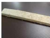
ภาพ 5 ลักษณะแผ่นวัสดุจากกระบวนการอัดแผ่นด้วยความร้อน (Hot pressing)
