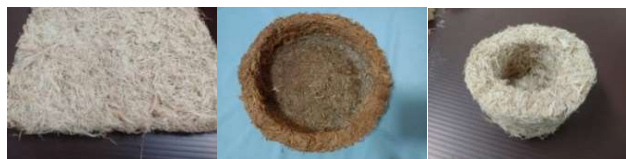
ภาพ 6 การทดลองขึ้นรูปเยื่อเปลือกทุเรียนแบบใช้พิมพ์ช่วย
