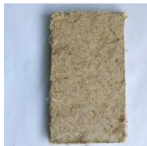
ภาพ 4 แผ่นวัสดุจากกระบวนการอัดแม่พิมพ์ (Mold compressing) ที่มีการพัฒนาจนมีเนื้อละเอียดและมีผิวเรียบสม่ำเสมอมากขึ้น
