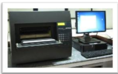
1. เครื่องทดสอบ ASTM C 518 ทดสอบสภาพนำความร้อน 2. เครื่องทดสอบ ASTM ความต้านแรงดึงสูงสุด รูปที่ 1 เครื่องทดสอบสภาพนำความร้อนและความต้านแรงดึงสูงสุด ที่มา: ถ่ายภาพเมื่อ กันยายน 2554.
