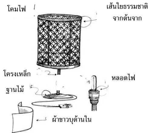
ภาพที่ 10 การขึ้นรูปโคมไฟด้วยการถักเส้นใยจากโดยใช้โครงลวด
