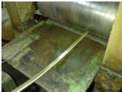
ภาพที่ 8-9 แสดงขั้นตอนในการรีด ทบและเคาะเนื้อเงิน
