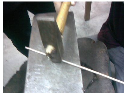
ภาพที่ 8-9 แสดงขั้นตอนในการรีด ทบและเคาะเนื้อเงิน
