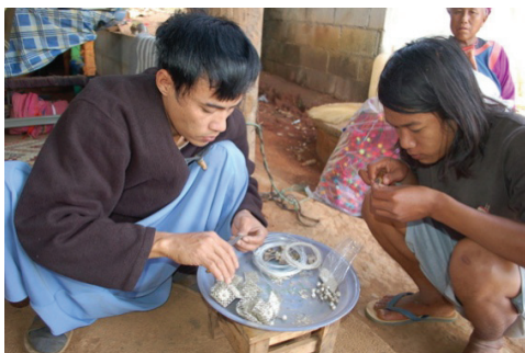
ภาพที่ 10-13 แสดงขั้นตอนในการขึ้นรูปทรงและลวดลายด้วยวิธีการดัด สลักดุน และฉลุ
