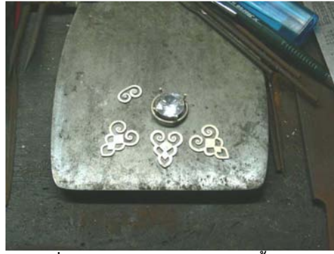
ภาพที่ 15 การตกแต่งลวดลายของจี้สร้อยคอ (ภาพโดย :จอมจรรย์ มะโนปัน บันทึกภาพ 9 มิถุนายน 2554)
