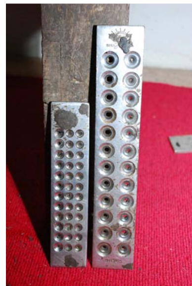
ภาพที่ 10 แผ่นดึงลวดใช้ดึงเงินให้มีลักษณะเป็นเส้น (ภาพโดย :จอมจรรย์ มะโนปัน บันทึกภาพ 7 มกราคม 2554)
