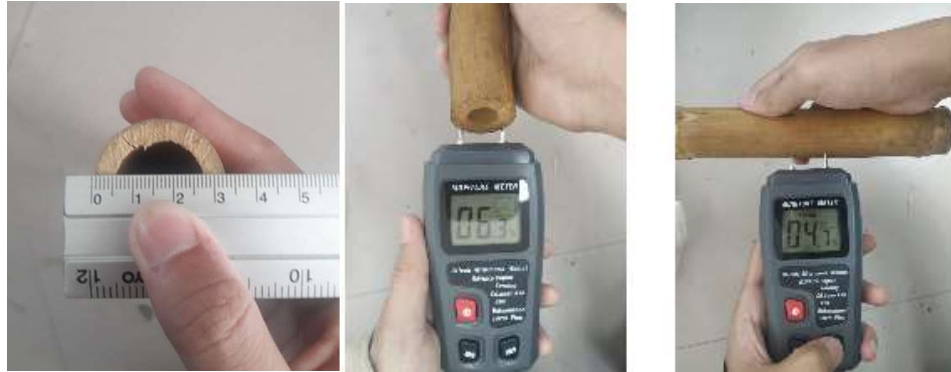
ภาพ 9 แสดงการเก็บข้อมูลขนาดและความชื้นไม้ไผ่ก่อน-หลังการทดลอง
