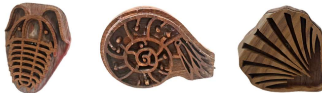
ภาพ 7 แม่พิมพ์บล็อกไม้สำหรับพิมพ์ลวดลายลงบนผ้า ที่มา : ศศิธร วิศพันธ์. 2565
