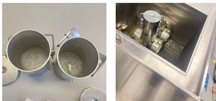
ภาพ 3 แสดงภาพการทดสอบความคงทนของสีต่อการซัก
