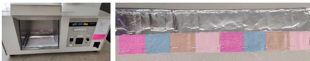
ภาพ 4 แสดงการทดสอบความคงทนของสีต่อแสง
