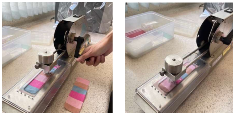
ภาพ 2 แสดงภาพการทดสอบความคงทนของสีต่อการขัดถู
