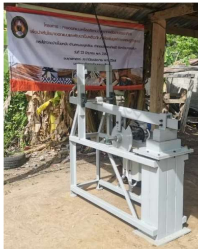
ภาพ 17 เครื่องตีกาบตาลจากพลังงานแสงอาทิตย์ ที่มา : ปราณี เท่ากลาง, ถ่ายภาพเมื่อวันที่ 23 มิถุนายน 2564
