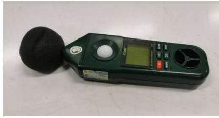
ภาพ 11 เครื่องวัดคลื่นความดังเสียงยี่ห้อ EXTECH รุ่น EN300 ที่มา : ปราณี เท่ากลาง, ถ่ายภาพเมื่อวันที่ 8 มิถุนายน 2564
