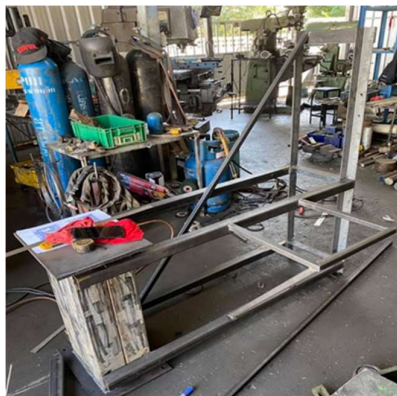
ภาพ 6 เหล็กกล่องนำมาประกอบเป็นโครงสร้างของตัวเครื่อง
