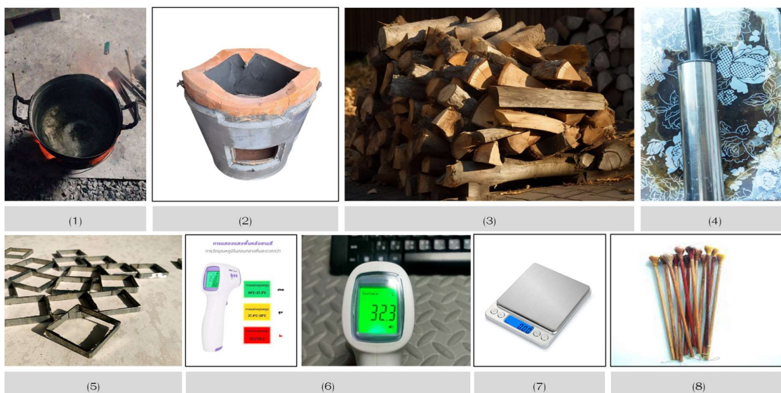
ภาพ 5 วัสดุและอุปกรณ์ที่ใช้ในการทดลอง (1) หม้อต้ม (2) เตาไฟ (3) เชื้อเพลิง (4) นวดขึ้นรูปวัสดุตัวอย่าง (5) แม่พิมพ์ ขนาด 5x5x0.5 ซม. (6) เครื่องวัดอุณหภูมิ (7) ตาชั่งดิจิตอล (8) ไม้คนส่วนผสมให้เข้ากัน
