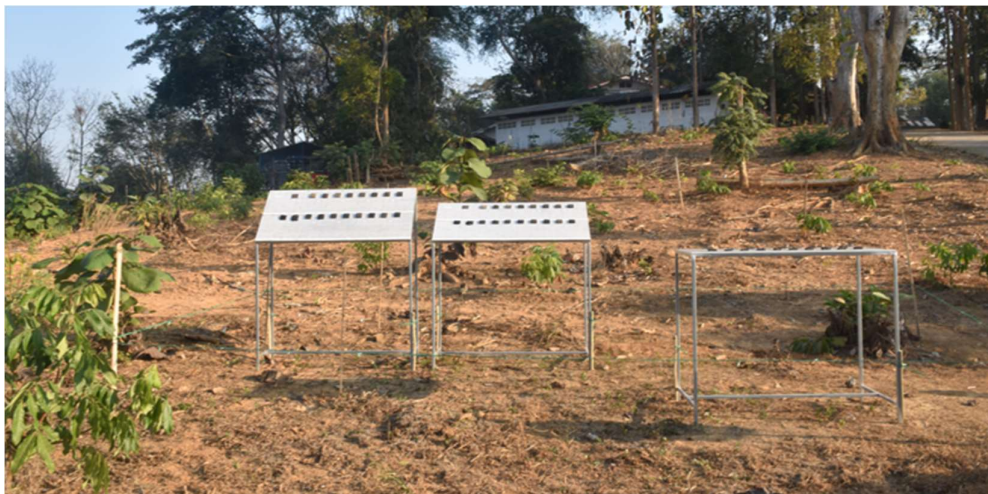
ภาพ 8 การนำวัสดุตัวอย่างไปตากด้วยแสงอาทิตย์
