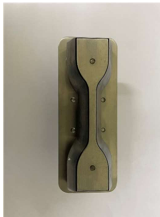
ภาพ 3 ใบมีดตัดตัวอย่างสำหรับทดสอบการทนต่อแรงดึง ใช้หัว Dumbbell ISO37, Type 1
