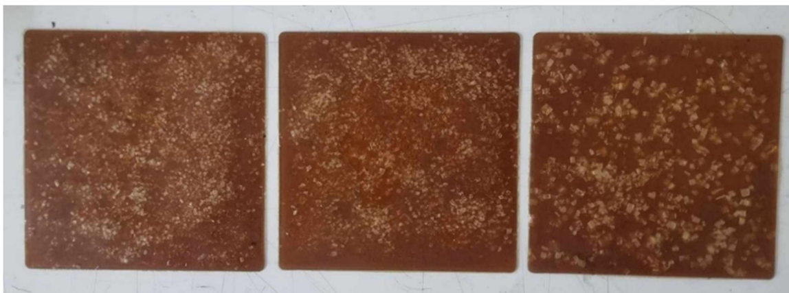
ภาพ 12 ชิ้นงานที่ใช้ในการทดสอบการลื่นไถล
