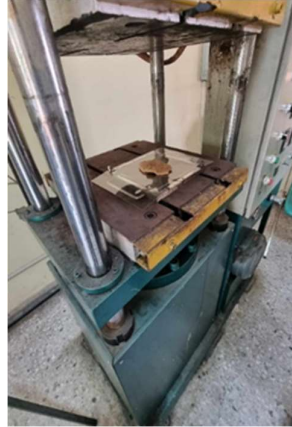
ภาพ 2 การขึ้นรูปกระเบื้องยางพาราผสมพลาสติกพีพี ด้วยเครื่องอัดขึ้นรูปด้วยความร้อน (Compression Molding)
