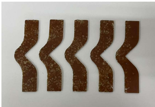
ภาพ 9 ชิ้นงานที่ใช้ในการทดสอบความทนต่อแรงฉีกขาด
