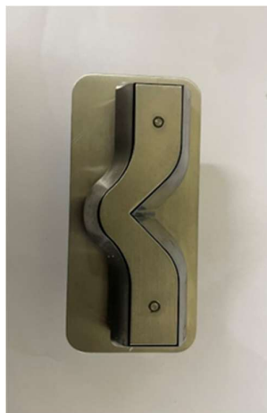
ภาพ 8 ใบมีดตัด tear ISO34-1/ASTM D624, Angle tear without nick
