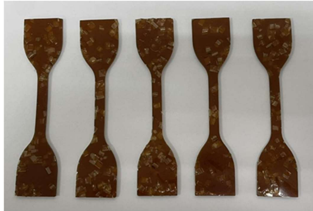
ภาพ 4 ชิ้นงานที่ใช้ในการทดสอบความทนต่อแรงดึง
