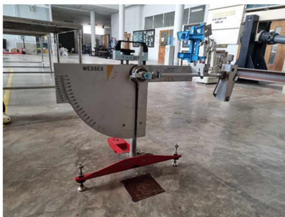
ภาพ 13 ทดสอบการลื่นไถลด้วยเครื่อง British Pendulum Number (BPN)
