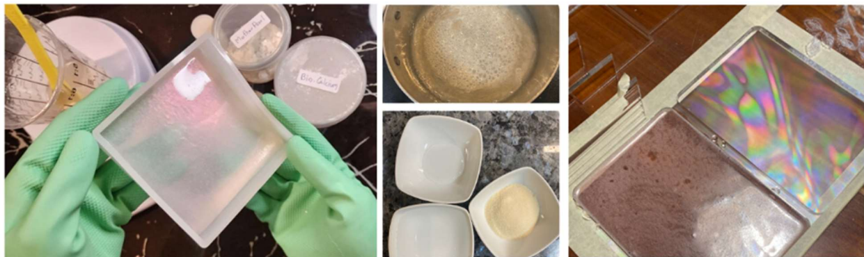
ภาพ 7 นวัตกรรมเส้นพลาสติกสำหรับเครื่องพิมพ์สามมิติ ผลิตจากเปลือกหอยและพลาสติกชีวภาพ. ปรับปรุงจาก “ภาพวิธีการแปรรูปเปลือกหอยแมลงภู,” โดย Researchworldthailand, 2566, https://www.researchworldthailand.com
