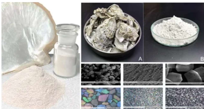
ภาพ 5 แคลเซียมคาร์บอเนตบริสุทธิ์ อัญรูปอะราโกไนต์ ซึ่งขนาดของแผ่นอยู่ที่ 3 – 7 ไมครอน. ปรับปรุงจาก “ผงแคลเซียมคาร์บอเนตที่แปรรูปจากเปลือกหอยแมลงภู่,” โดย ผู้จัดการออนไลน์, 2565, https://mgronline.com/science/detail/9650000104923
