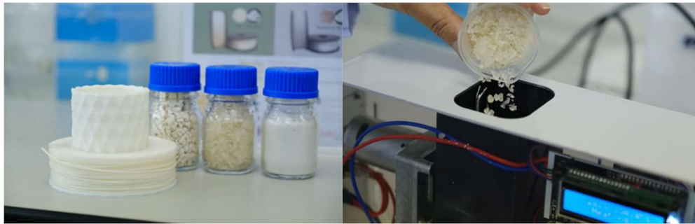
ภาพ 6 เปลือกหอยที่ผ่านกระบวนการแปรรูป สู่ ไบโอนาโนแคลเซียมคาร์บอเนต. ปรับปรุงจาก “ภาพเปลือกหอยที่ผ่าน กระบวนการแปรรูป,” โดย ผู้จัดการออนไลน์, 2565, https://mgronline.com/science/detail/9650000104923
