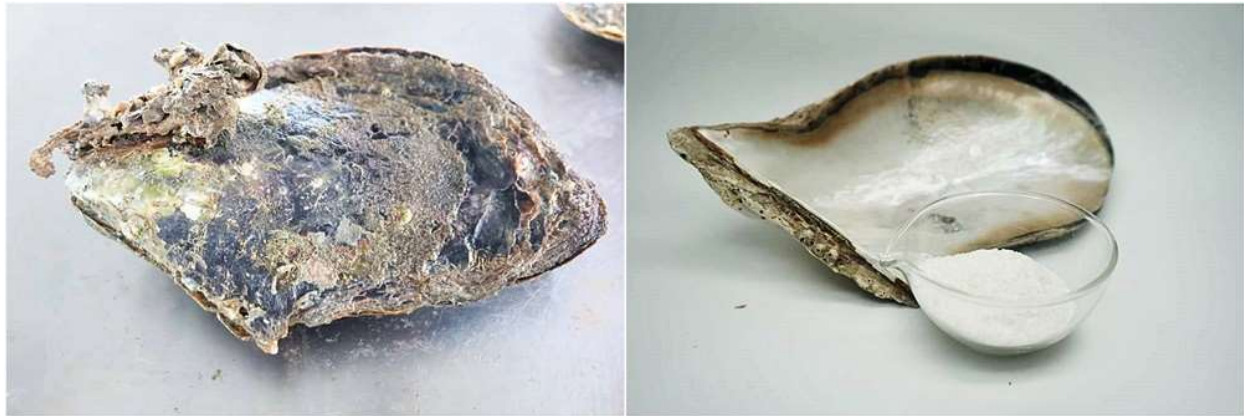
ภาพ 4 เปลือกหอยที่ผ่านกระบวนการแปรรูป สู่ ไบโอโนแคลเซียมคาร์บอเนต. ปรับปรุงจาก “วช. หนุณงานวิจัย ม.เกษตร มุ่งส่งเสริมโครงการพัฒนามูลค่าการเลี้ยงหอยมุก สู่อุตสาหกรรมความงามและสุขภาพ,” โดย Somchai T., 2566, https://www.thaipublicmedia.com
