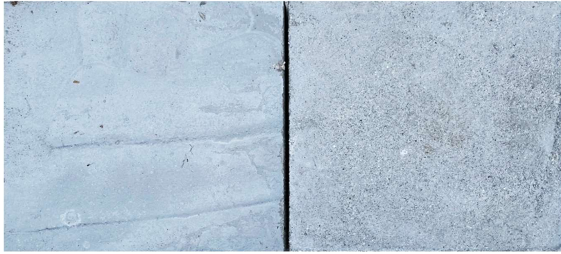
ภาพ 2 เปรียบเทียบแผ่นกระเบื้อง OPC (ด้านซ้าย) และ S1 ด้านขวา
