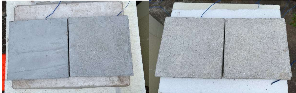
ภาพ 6 แสดงการทดลองเปรียบเทียบระหว่างพื้นลาดฟ้าแบบมีแผ่นกระเบื้องซีเมนต์ 100% (OPC) กับแผ่นซีเมนต์ผสมโพลีเมอร์ (S1)
