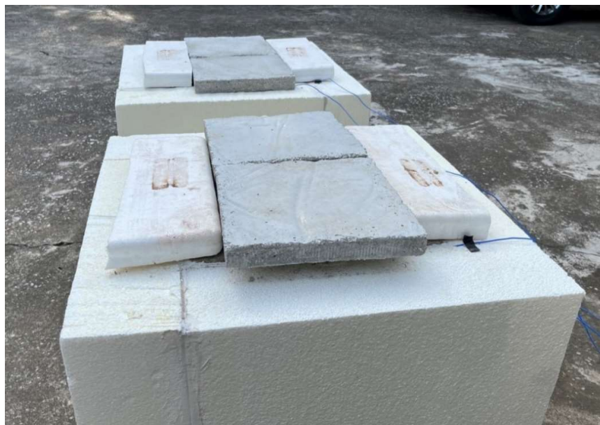
ภาพ 8 แสดงการทดลองเปรียบเทียบระหว่างพื้นคืดฟ้าที่มีแผ่นซีเมนต์ผสมโฟม (S1) ทับคืดฟ้าด้านบน กับแผ่นซีเมนต์ผสมโฟม (S1) วางยกคืดฟ้าจากพื้น 2.5 ซม
