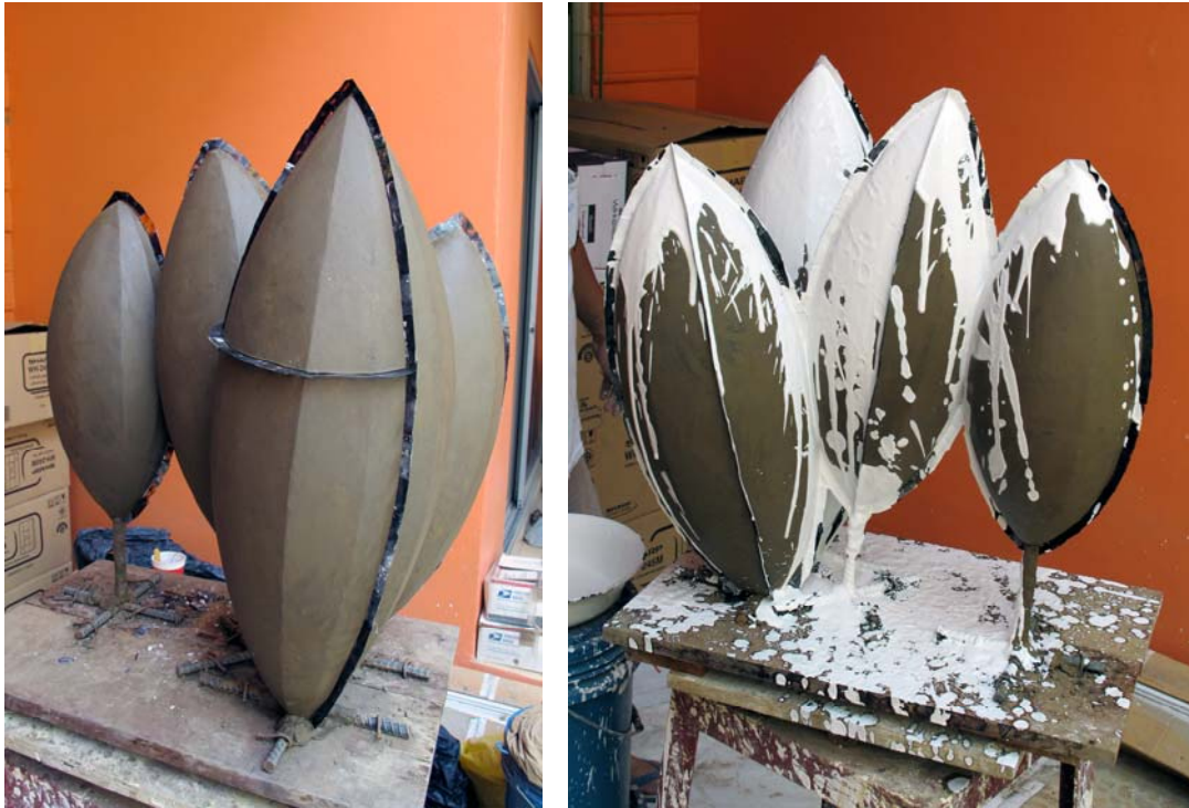
ภาพ 16-17 การแบ่งต้นแบบดินด้วยฟิล์มภาพยนตร์เก่า และการตีปูนปลาสเตอร์
