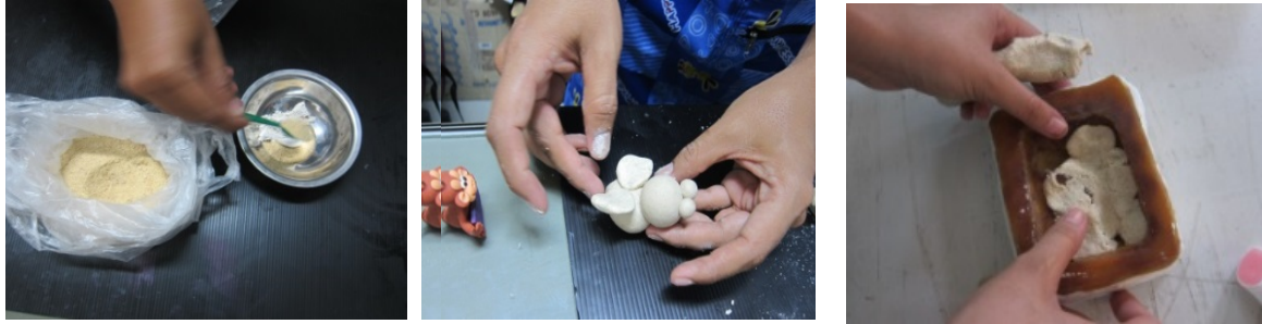
ภาพ 8 ทดลองนำกากถั่วเหลืองผสมกับกาวแล้วนำไปปั้นและกดลงบนแม่พิมพ์
