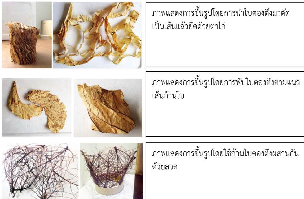
ภาพ 6 ภาพแสดงการทดสอบและทดลองขึ้นรูปวัสดุด้วยวิธีการไม่ใช้วัสดุประสาน
