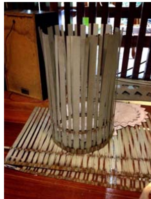
ภาพ 7 ส่วนระย้า ตัดแผ่นโลหะเป็นเส้นๆ และประกอบเข้าด้วยกันโดยการเชื่อม
