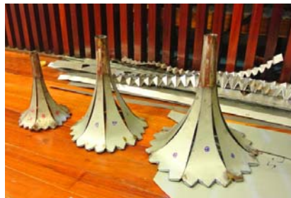
ภาพ 5 นำแผ่นโลหะที่ตอกกลายแล้วมาขึ้นรูปโดยวิธีการพับ
