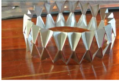
ภาพ 5 นำแผ่นโลหะที่ตอกกลายแล้วมาขึ้นรูปโดยวิธีการพับ
