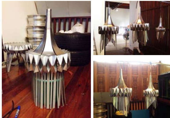
ภาพ 8 นำส่วนของผลิตภัณฑ์ทั้ง 3 ส่วนมาประกอบเข้าด้วยกัน และใช้กรรไกรตัดแต่งในส่วนของระย้าให้ลงตัว จากนั้นทำสีชิ้นงานให้เรียบร้อย
