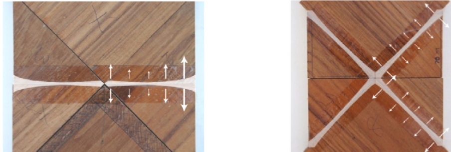
ภาพ 9 แสดงการทดสอบแรงดึงที่เกิดขึ้นในการใช้สอย
