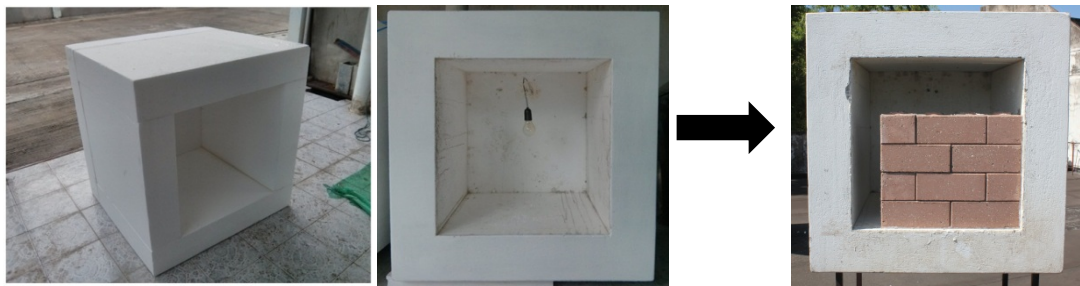
ภาพ 6 แสดงลักษณะกล่องทดลองด้านความร้อนและตำแหน่งของวัสดุทดลอง
