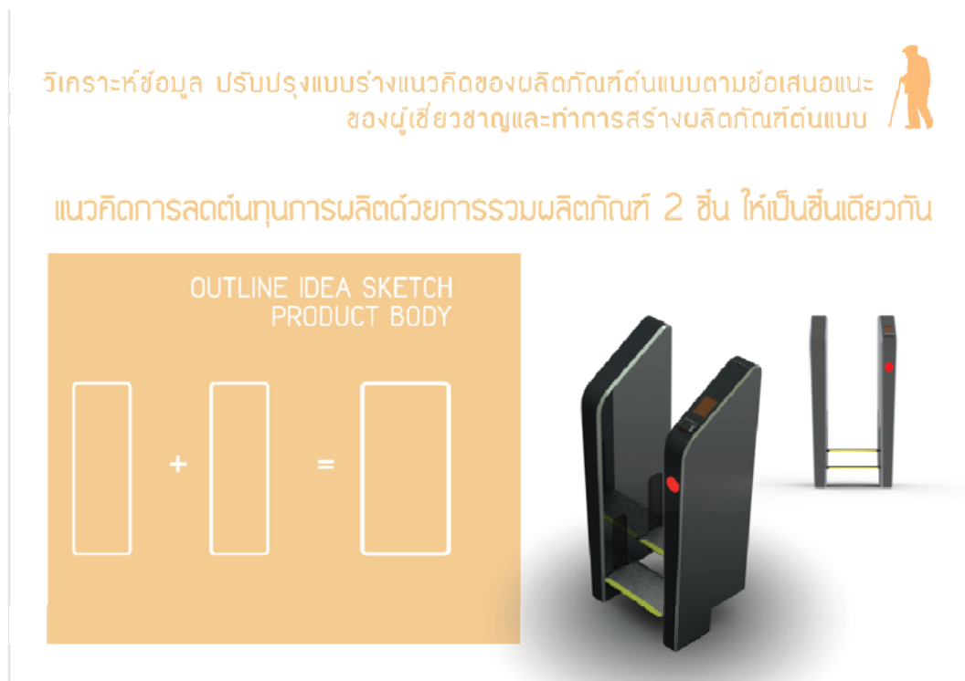
ภาพ 9 แนวคิดการลดต้นทุนการผลิตด้วยการรวมผลิตภัณฑ์ 2 ชิ้น ให้เป็นชิ้นเดียวกัน
