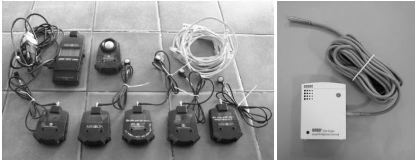
ภาพที่ 6 แสดงอุปกรณ์ที่ใช้เก็บข้อมูลวัดค่าความส่องสว่าง Illuminance meter (ภาพถ่าย) และวัดค่าอุณหภูมิ HOBO (ภาพถ่าย)
