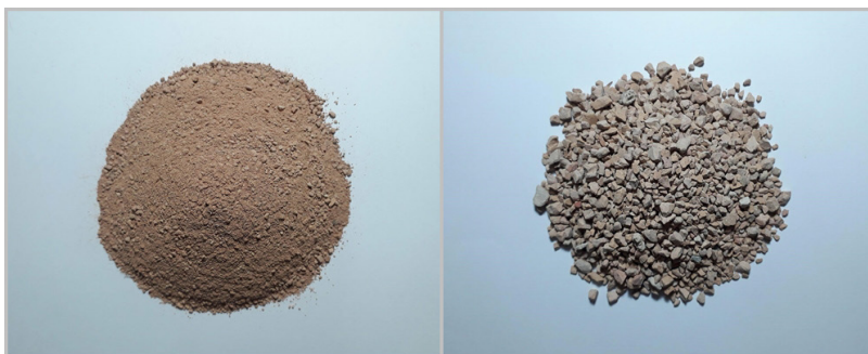
ภาพที่ 2 แสดงตัวอย่างขนาดอนุภาคของวัสดุเคลือบใช้เซรามิกส์ประเภทกระเบื้องรีด (หลังเผา) หลังทำการบด
