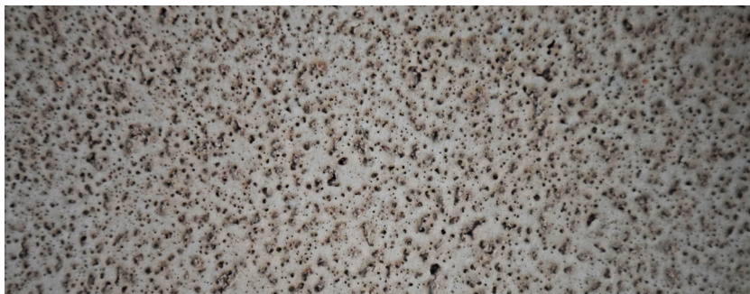
ภาพที่ 3 แสดงลักษณะทางกายภาพของวัสดุเซรามิกส์ฟรูนที่มีความเหมาะสมมากที่สุด (สูตร PC57)
