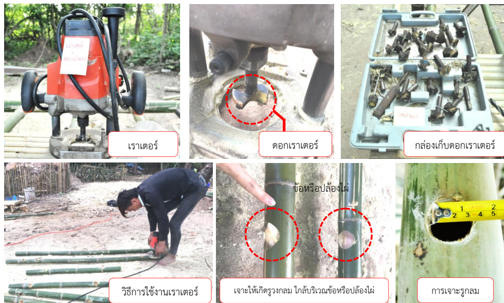
ภาพที่ 13 แสดงเครื่องเราเตอร์และดอกเราเตอร์ที่ใช้สำหรับเจาะลำไม้
