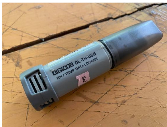
ภาพที่ 11 แสดงเครื่องมือ USB Data Logger ยี่ห้อ DIGICON รุ่น DL-TH-USB
