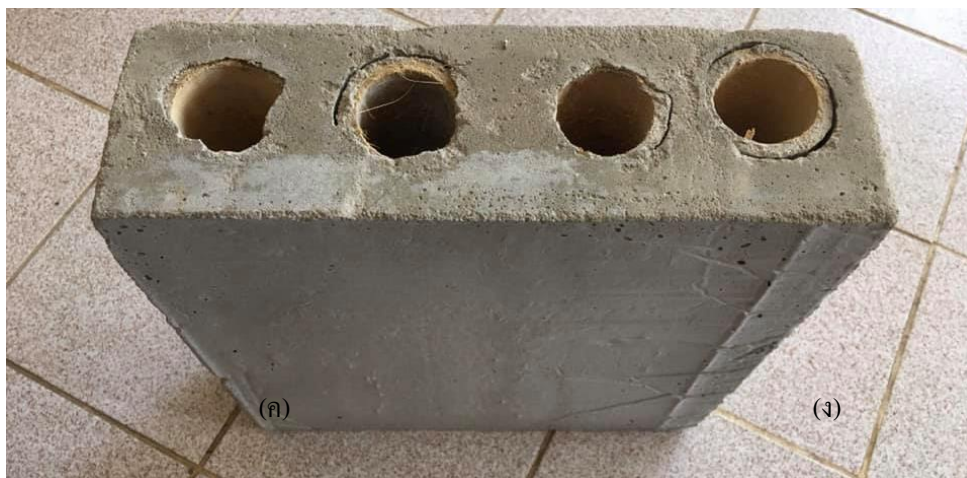
ภาพที่ 2 บล็อกซีเมนต์ล้าไม้ไผ่ขนาด 30 \times 30 \times 10 เซนติเมตร
