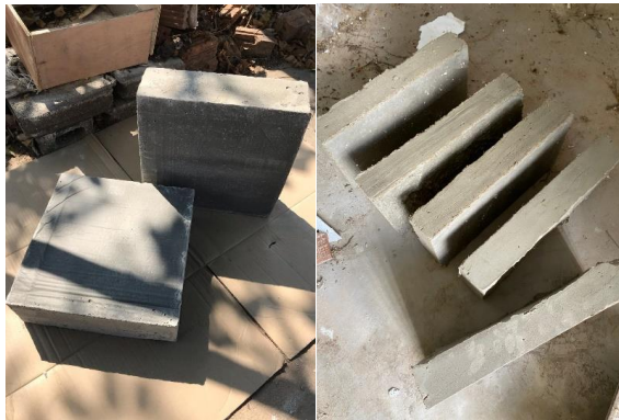
ภาพที่ 3 เปรียบเทียบบล็อกซีเมนต์เสริมลำไม้ไผ่ ขนาด 30x30x10 เซนติเมตร (ซ้าย) และ ขนาด 39x19x7 เซนติเมตร (ขวา)
