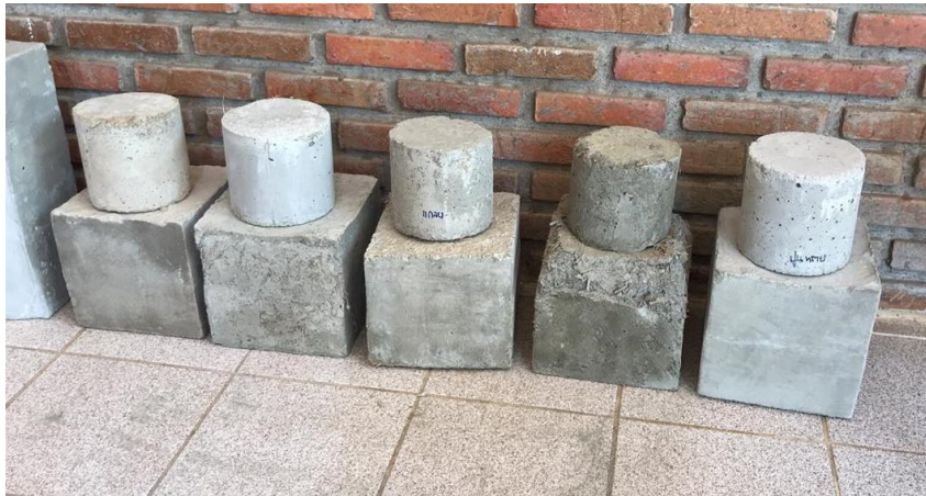
ภาพที่ 5 แสดงแบบหล่อรูปลูกบาศก์ และ แบบหล่อรูปทรงกระบอกของซีเมนต์ผสมใยพืชน้ำ
