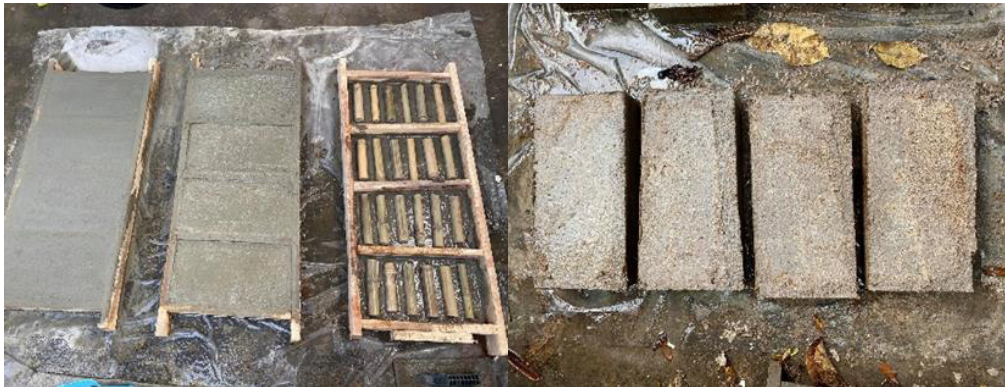
ภาพที่ 8 แสดงการขึ้นรูปบล็อกซีเมนต์เสริมล้าไม้ไฟผสมใยพืชทุกชนิดพร้อมกันทั้งหมด
