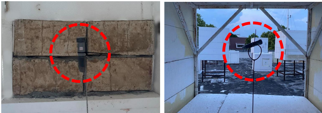
ภาพที่ 15 แสดงการวางเครื่องมือ USB Data Logger ยี่ห้อ DIGICON รุ่น DL-TH-USB (ก) การติดตั้งในกล่องทดสอบ (ข) การติดตั้งเซ็นเซอร์ตรวจวัดอากาศภายนอก
