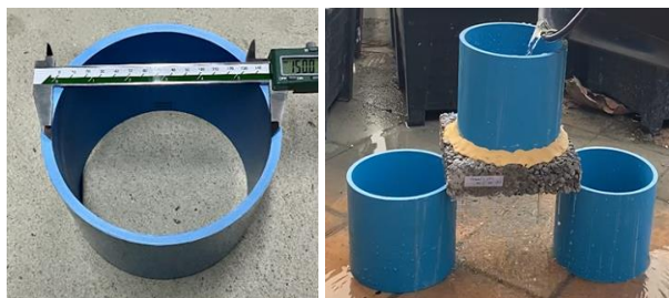
ภาพที่ 3 การติดตั้งวงแหวนที่ทำการทดสอบการซึมผ่านน้ำ
